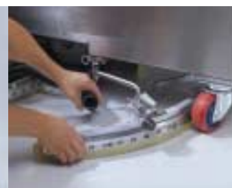
Enkelt byte av saggummi
